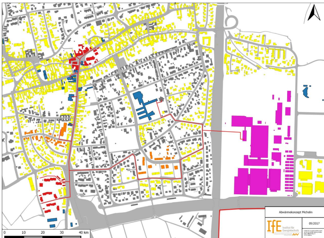
Abbildung 3: Trassenverlauf - Nahwärmenetz Stadt Hallstadt
